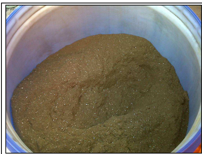
Fig. 43: Materiale pulverulento sottovaglio mulino a barre
