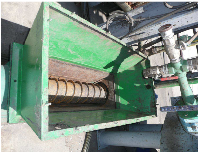
Fig. 42: Pompa Novarotors – particolare tramoggia di carico
