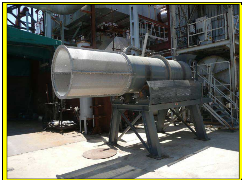
Fig. 38: Mulino a barre – vista d'insieme
