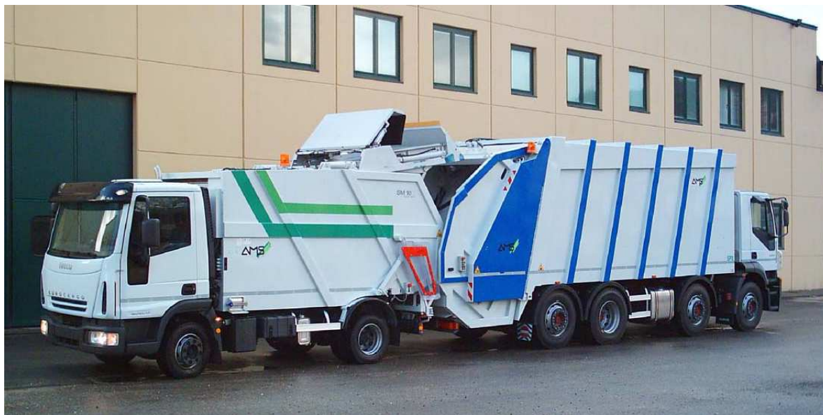
Figura 3 – Esempio di trasbordo da un minicompattatore (7,00m 3 ) ad un compacttatore di capacità media o grande (25,00 ÷ 30,00 m 3 )
