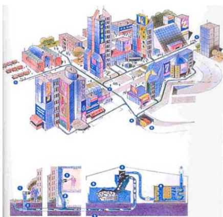
Fig.5. Schema di RT pneum con centrale fissa
